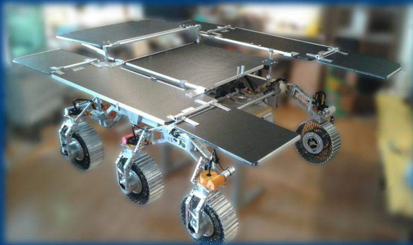
Το πρωτότυπο rover πριν τοποθετηθούν τα φωτοβολταϊκά στοιχεία
