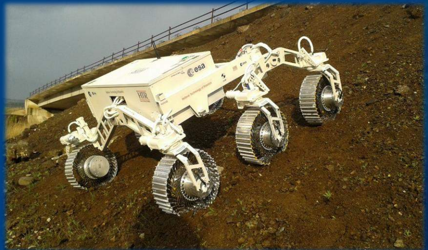
Το πρωτότυπο rover σε θέση ανάβασης αποκλειστικά με χρήση ενέργειας από την μπαταρία του
