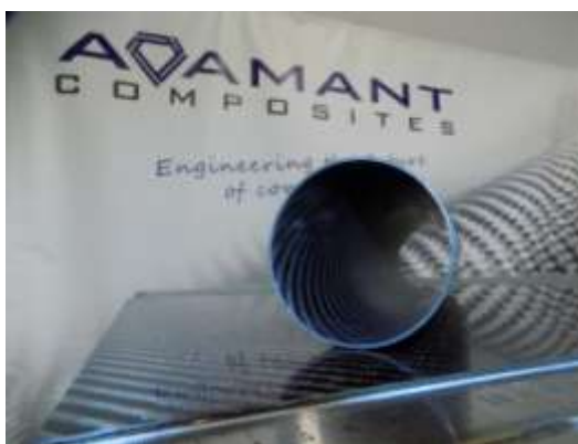
Κυλινδρικές δομές σύνθετων υλικών (εσωτερική διάμετρος: 2.75")
