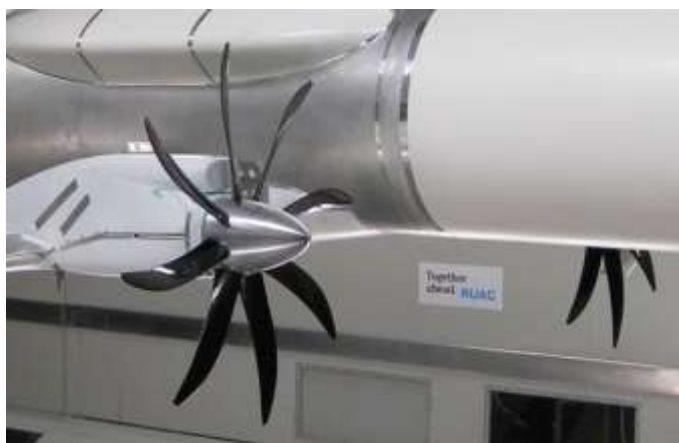
Πτερύγια κινητήρα αεροσκάφους - δοκιμή σε αεροσύραγμα (RUAG)
