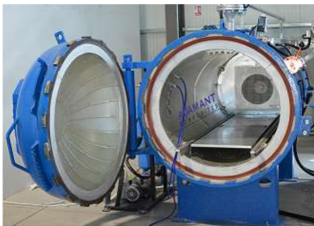
Αυτόκλειστος Φούρνος (διάμετρος: 1m, μήκος: 2m)
